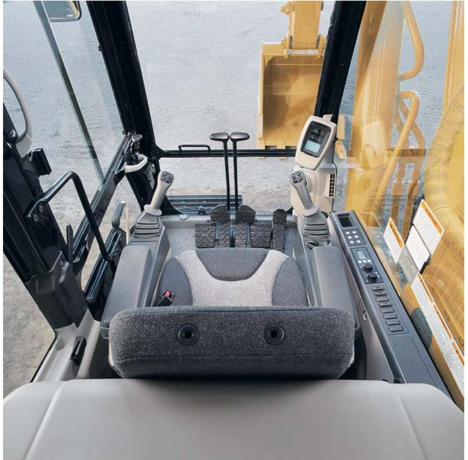
**Parabrisas.** El parabrisas superior delantero puede ser abierto, cerrado y alejado bajo el techo arriba del operador, aumentando su visibilidad. Tirantes en la parte intermedia inferior del parabrisas facilitan su apertura. Además utiliza un vidrio plano que facilita su reemplazo a un bajo costo.
